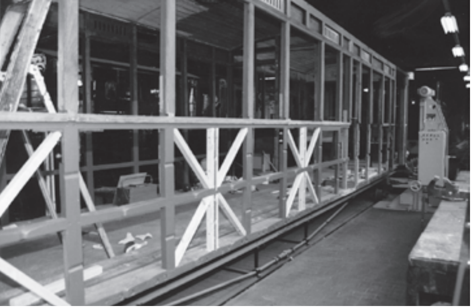
De volledig uitgekleden rijtuigbak van de AB 6 in Hoorn. (foto: Marius van Rijn)
