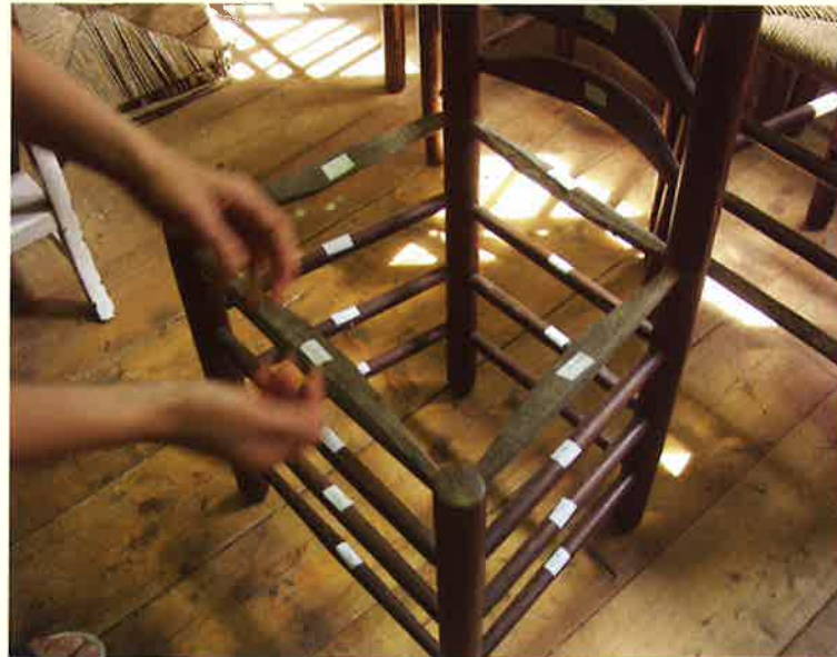
Een kerkstoel met genummerde onderdelen vóór demontage, juni 2003.
